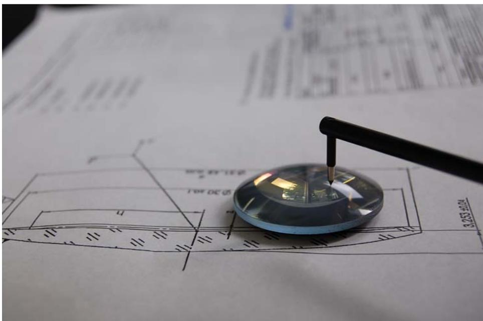
Dabei werden die Asphären auf speziellen Maschinen feinstgeschliffen und erhalten eine derart plane Oberfläche, dass sie sofort korrigiert werden können und in der Regel ein Arbeitsschritt, das Polieren, eingespart werden kann. Die Vermessung erfolgt mit einer eigens angepassten Messtechnik über Asphäreninterferometer oder Hologramme.
